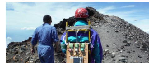
4 電池駆動ガスセンサーシステム野外テスト
